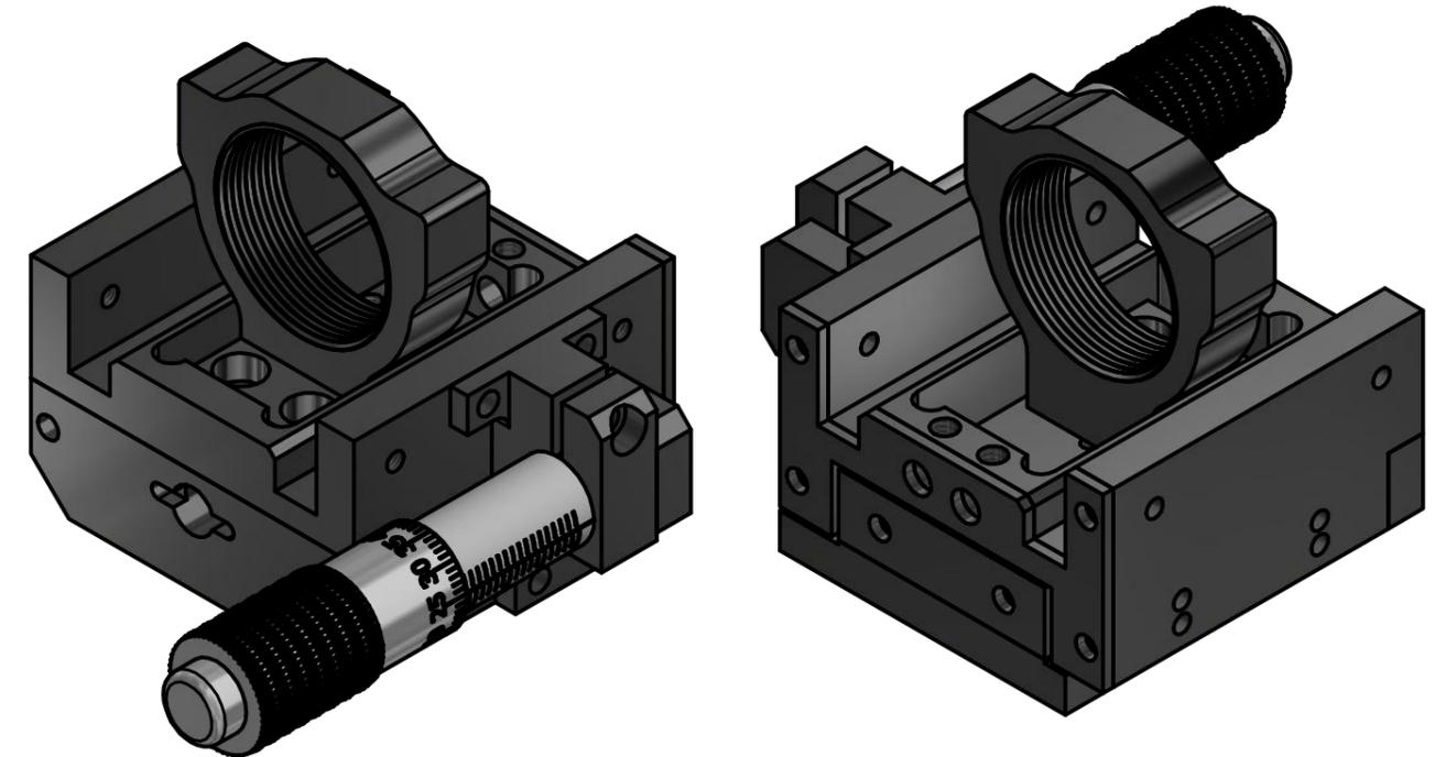
Транслятор устанавливается в каркасную систему 30 мм и фиксируется винтами М3. Диапазон юстировки 15 мм, осуществляется микрометрическим винтом MS15. Транслятор имеет резьбовое отверстие SM1 для установки оптических элементов и тубусов. Устанавливается на монтажные стержни RSS6 и фиксируется винтами М3.
