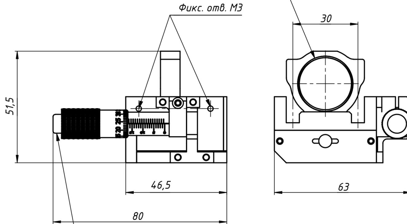
Микрометрический винт MS 15
